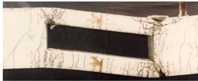
Hình 10: Trạng thái phá hoại dẻo của dầm dưới tác dụng đồng thời của mô men và lực cắt
