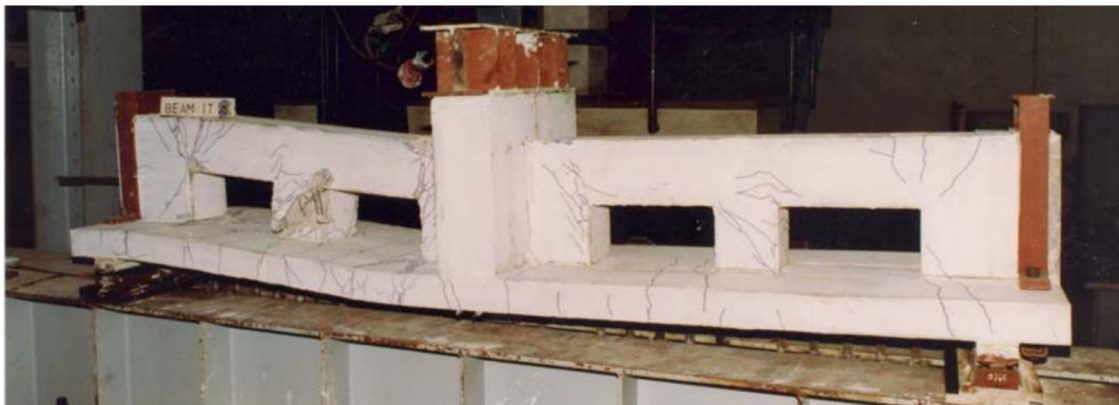
Hình 17: Thí nghiệm dầm có nhiều lỗ mở
