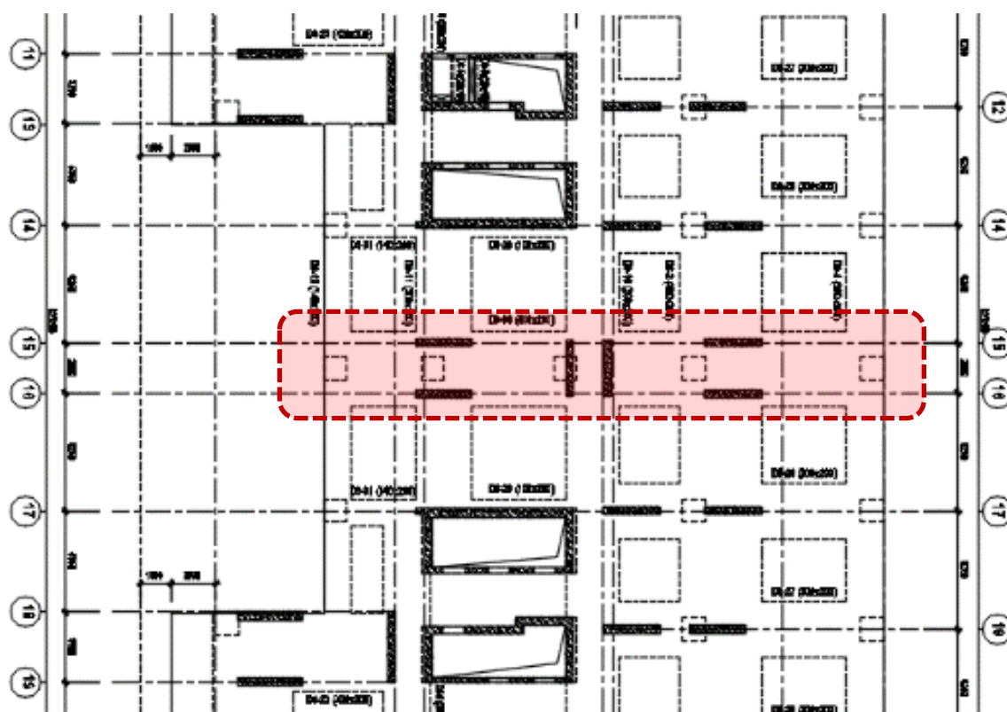
Hình 8: Mặt bằng kết cầu tầng chuyển
