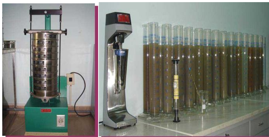
(Hình 4: Thí nghiệm thành phần hạt)
