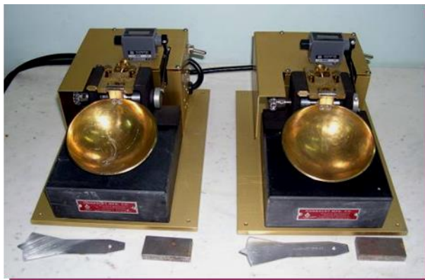
(Hình 6: Thí nghiệm giới hạn chảy - dẻo)
