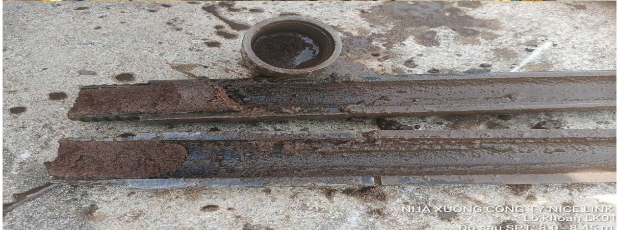
NHÀ XƯỞNG CÔNG TY NICE LINK Lỗ khoan LK01 Độ sâu SPT: 8.0 - 8.45 m
