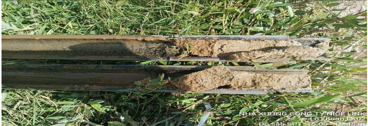
NHÀ XƯỞNG CÔNG TY NICE LINK Lỗ khoan LK02 Độ sâu SPT: 15.00 - 15.45 m
