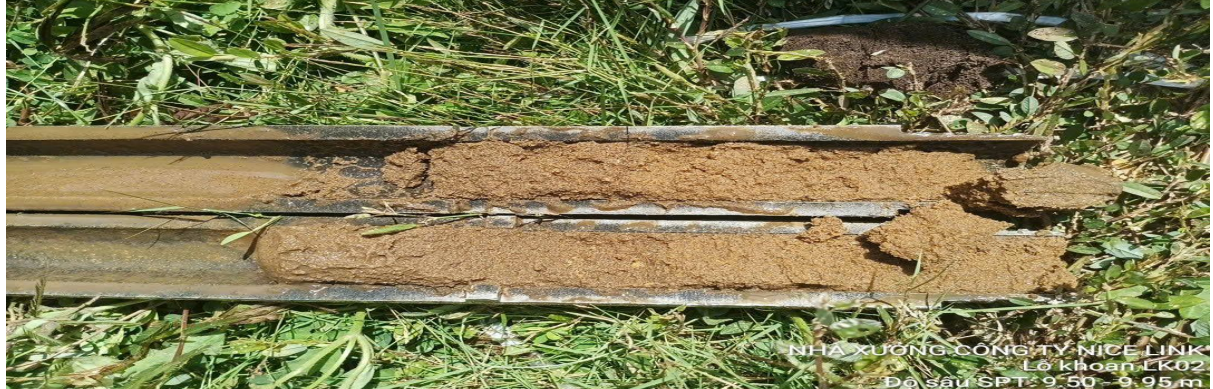
NHÀ XƯỞNG CÔNG TY NICE LINK Lỗ khoan LK02 Độ sâu SPT: 9.50 - 9.95 m
