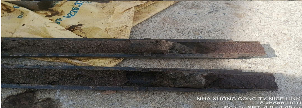
NHÀ XƯỞNG CÔNG TY NICE LINK Lỗ khoan LK01 Độ sâu SPT: 4.0 - 4.45 m
