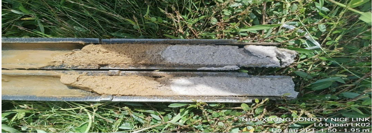
NHÀ XƯỞNG CÔNG TY NICE LINK Lỗ khoan LK02 Độ sâu SPT: 1.50 - 1.95 m
