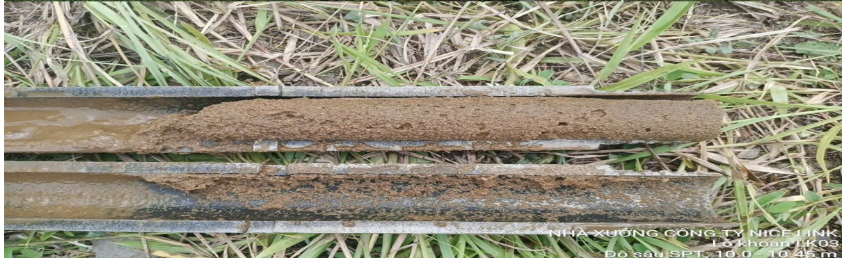
NHÀ XƯỞNG CÔNG TY NICE LINK Lỗ khoan LK03 Độ sâu SPT: 10.0 - 10.45 m
