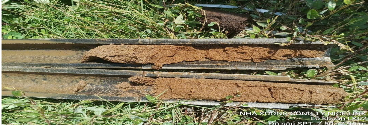
NHÀ XƯỞNG CÔNG TY NICE LINK Lỗ khoan LK02 Độ sâu SPT: 7.50 - 7.95 m
