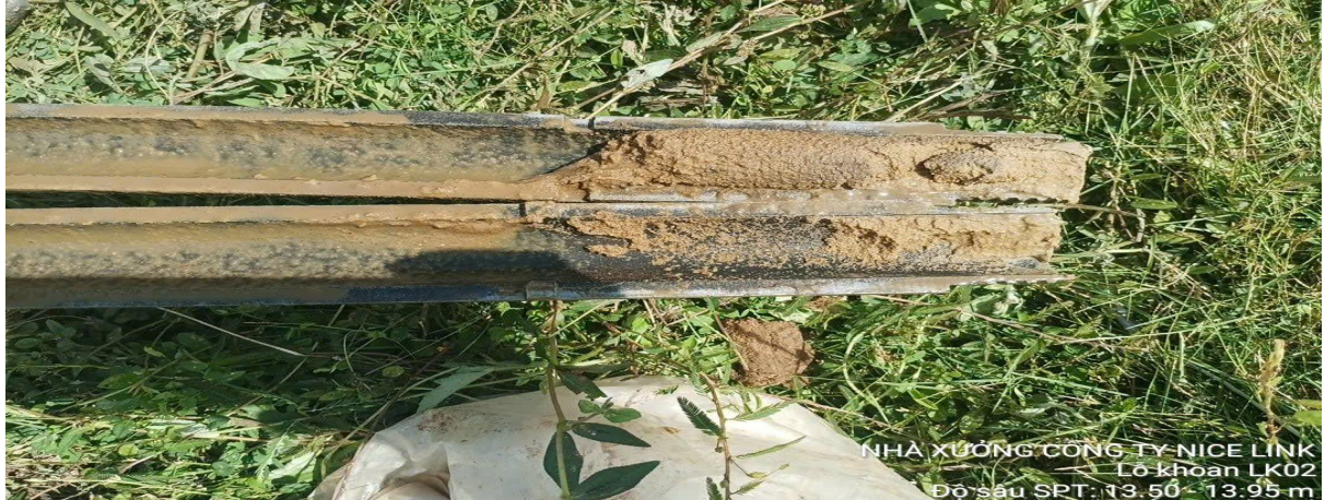
NHÀ XƯỞNG CÔNG TY NICE LINK Lỗ khoan LK02 Độ sâu SPT: 13.50 - 13.95 m
