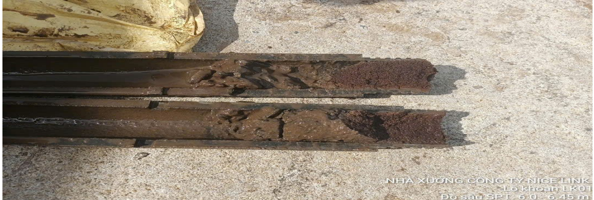
NHÀ XƯỞNG CÔNG TY NICE LINK Lỗ khoan LK01 Độ sâu SPT: 6.0 - 6.45 m
