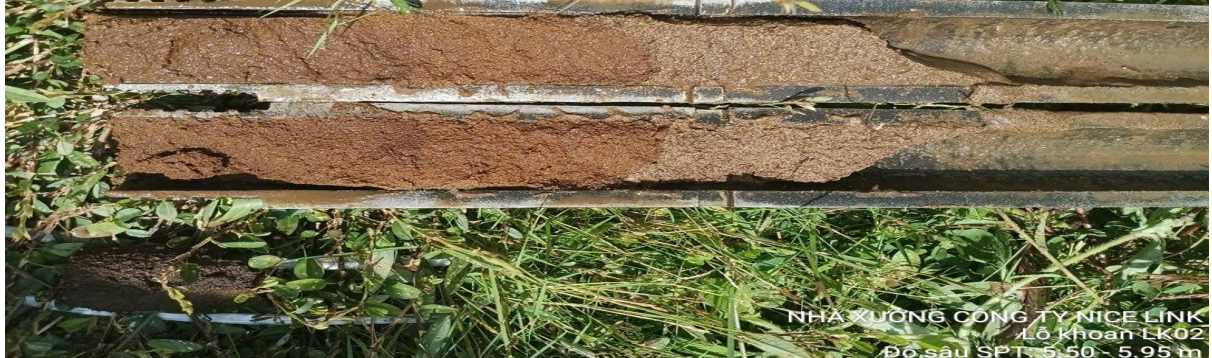
NHÀ XƯỞNG CÔNG TY NICE LINK Lỗ khoan LK02 Độ sâu SPT: 5.50 - 5.95 m
