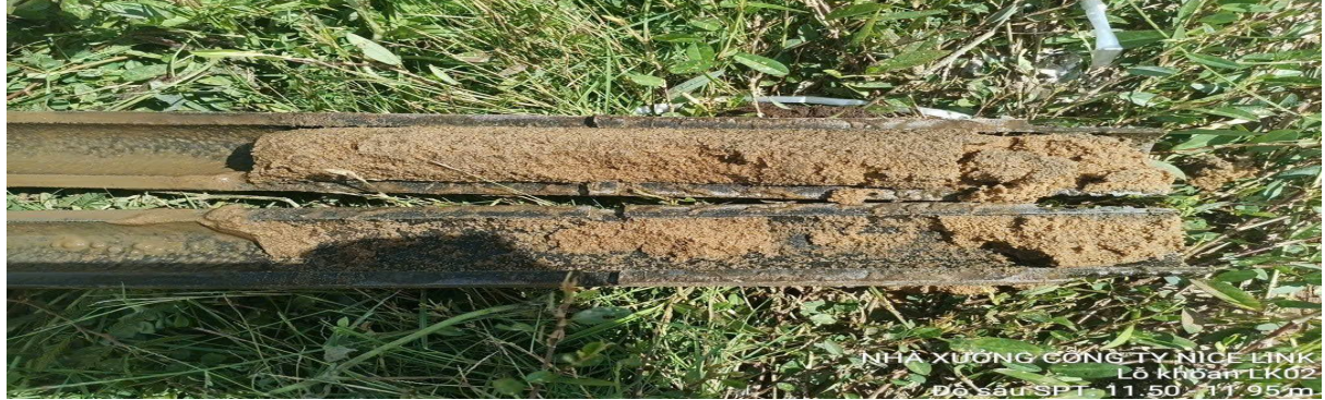
NHÀ XƯỞNG CÔNG TY NICE LINK Lỗ khoan LK02 Độ sâu SPT: 11.50 - 11.95 m
