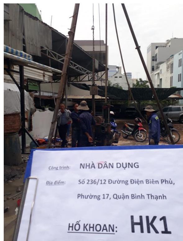
Hình 4: Thực hiện thí nghiệm SPT
